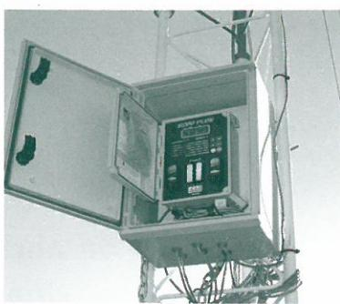
Detalle do rexistrador: Logger 9200 Plus de NRG e o seu armario de protección.
